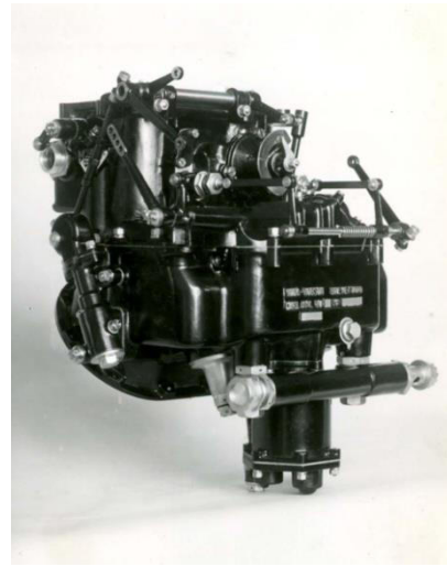
Neg.1008 Carburatore Mona AVT-80B Installato sui motori: Alfa Romeo 126 e 127, Walter Castor e Venus e Piaggio P.XI
