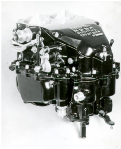
Neg.1018 Carburatore Mona AVT-85MC Installato sui motori: Alfa Romeo 126 ed Isotta Fraschini Delta
