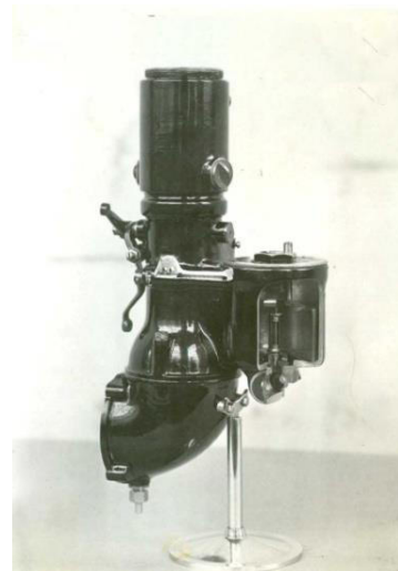
Neg.318 Carburatore Zenith 55IF Installato sui motori: Isotta Fraschini V-6
