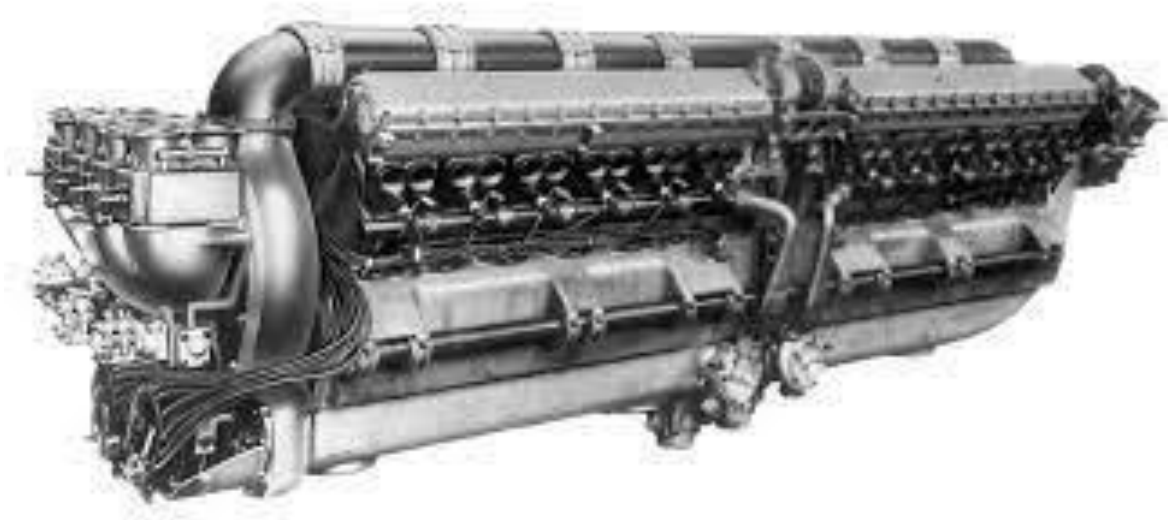
Motore aeronautico da competizione Fiat AS.6 - 24 cilindri a V di 60° - Cilindrata 50,256 litri – Potenza 3100 Cv. a 3300 giri/min
